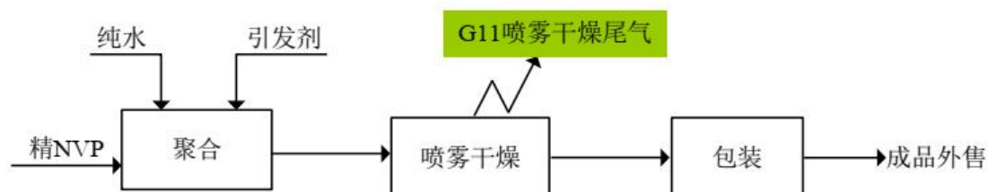
图 4-11 PVPK30 粉生产工艺流程及产污环节图
