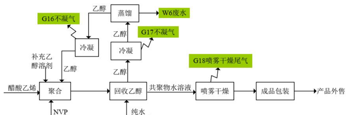
图 4-15 VP/VA 共聚物生产工艺流程及产污环节图
